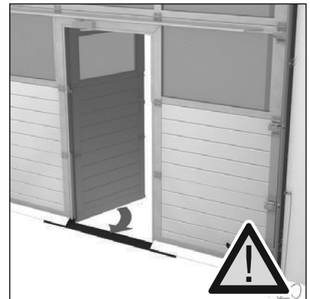
6. Zawsze sprawdzaj, czy drzwi przejściowe są zamknięte przed otwarciem drzwi sekcyjnych.
